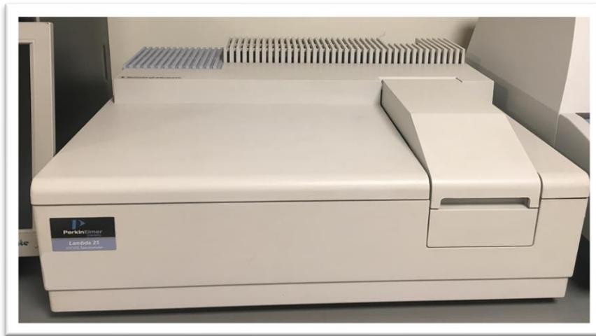
È uno strumento che permette di misurare l'attenuazione delle singole lunghezze d'onda che passano attraverso il campione.
